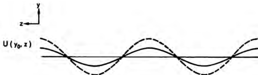
Rys. 18b. Wpływ proponowanego selektywnego oddziaływania na warstwę przyściennej na rozkład prędkości w pł. y-z dla y = y_0 [53]
