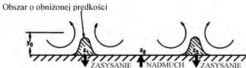
Rys. 18a. Koncepcja selektywnego oddziaływania na warstwę przyściennej poprzez lokalne zasysanie i nadmuchi [53]
