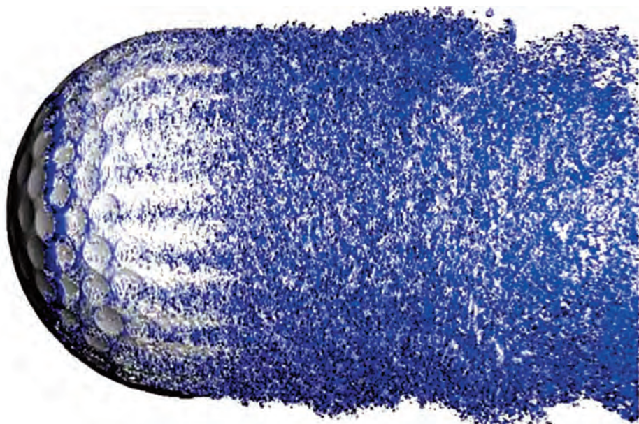
Rys. 15. Numeryczny model opływu piłki golfowej z wkłnięciami przy V = 40 m/s (bez uwzględnienia ruchu wirowego) [43]
