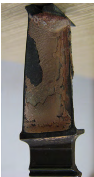
Rys. 10. Łopatka turbiny z przylegającym spieczonym pyłem
