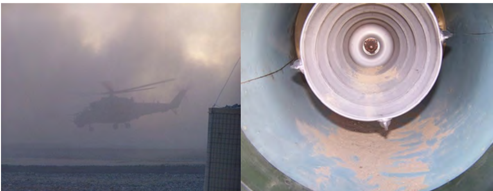
Rys. 8. Zawis śmigłowca w strefie silnego zapylenia i widok kanału dolotowego do jego silnika podczas wykonywania obrotów polotowych
