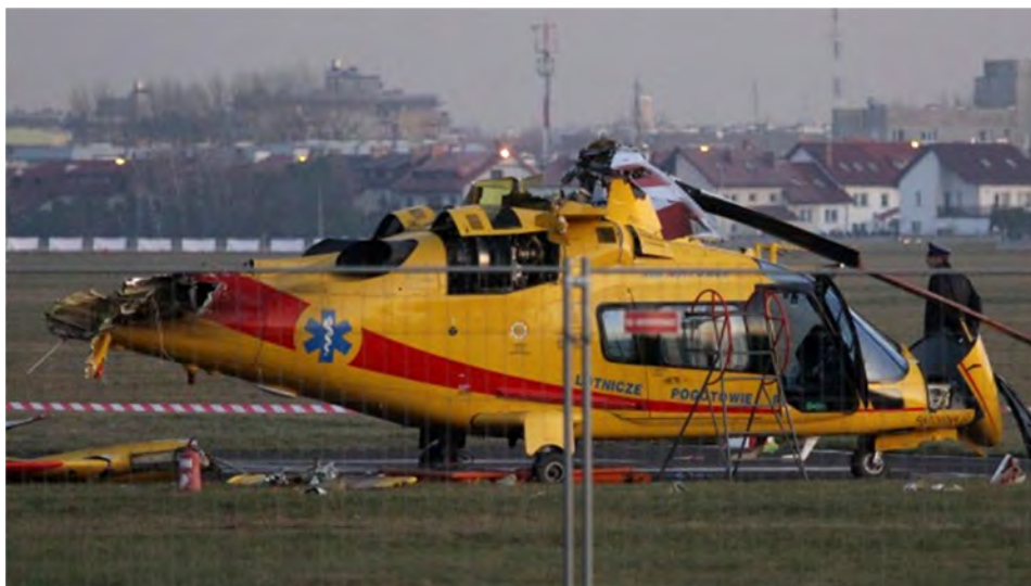
Rys. 3. Skutki rezonansu przyziemnego śmigłowca Agusta A 109 Power należącego do LPR (fot. internet)
