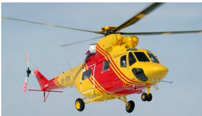
Rys. 5. Śmigłowiec W-3 Sokół z widocznym podwoziem kołowym (fot. Internet)
