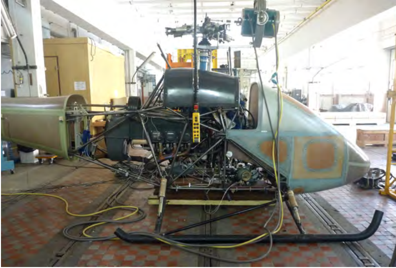
Rys. 9. Śmigłowiec ILX-27 w trakcie badań rezonansowych (fot. materiały własne ILOT)
