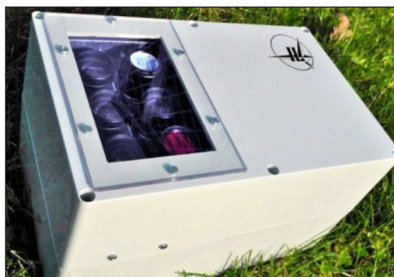
Kamera wielospektralna zbudowana w Zakładzie Teledetekcji
