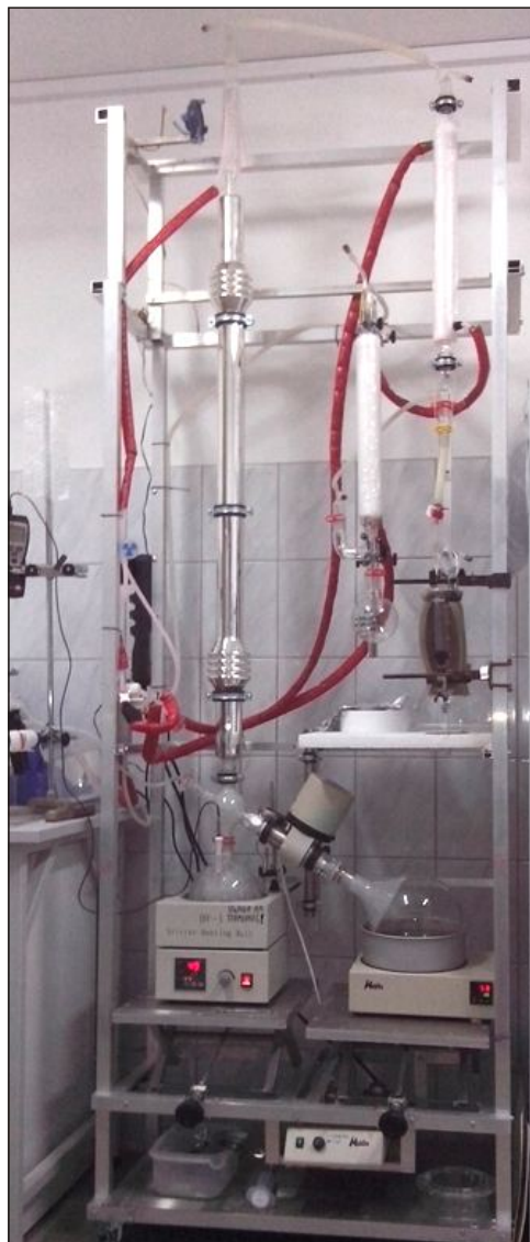
Układ do załężania i oczyszczania nadtlenu wodoru
